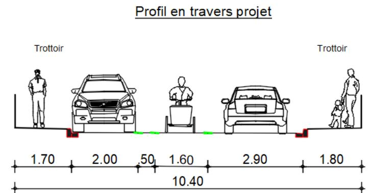
Exemple Coupe type du déploiement de la mise en sens unique
